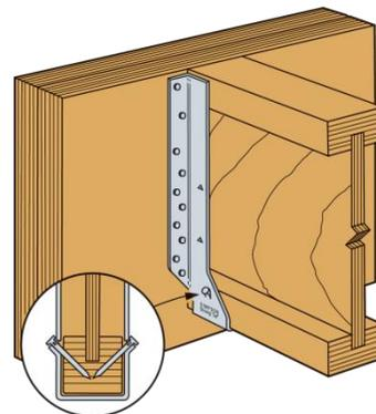
FIGURE 16B—ALTERNATE MIU JOIST HANGER INSTALLATION
