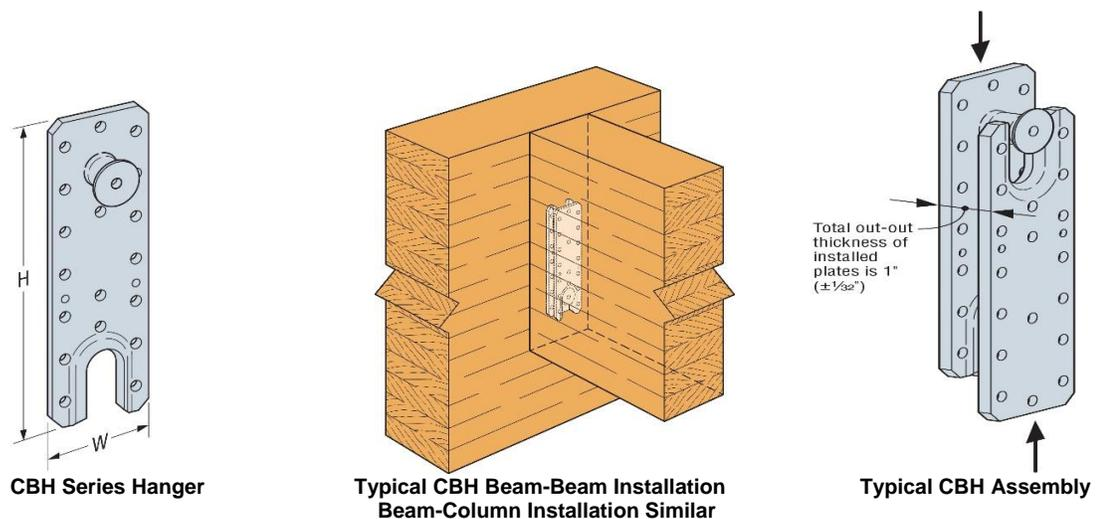
FIGURE 18—CBH CONCEALED BEAM HANGERS
